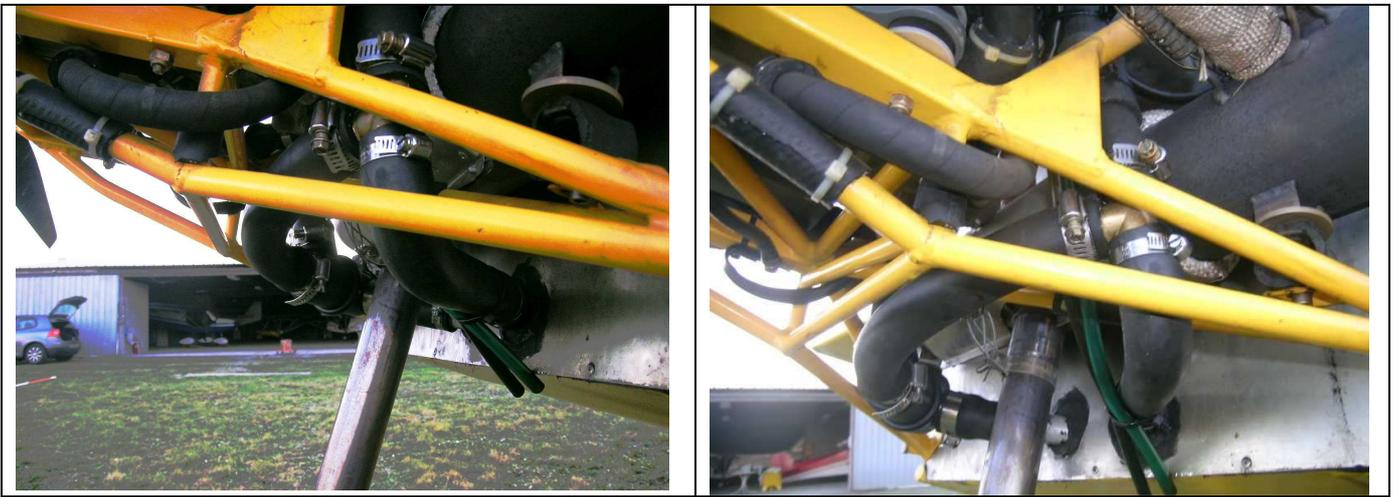
12) Remplir le circuit avec un liquide de refroidissement à base de Glycol.
